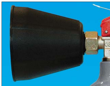
Le diffuseur est en polyamide. Il sert à diffuser parfaitement le produit extincteur et garantir en étouffement et refroidissement rapide de l'incendie.
